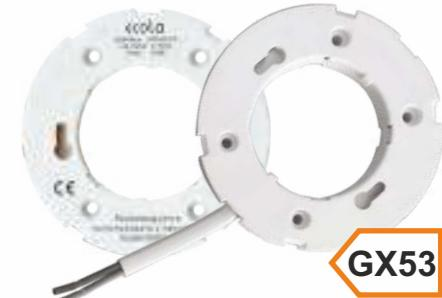
Проходные контакты удобны, когда необходимо последовательно соединить несколько патронов в одну цепь. Под крышечкой патрона безвинтовые контакты. К патрону подводится с одной стороны два провода от сети 220V, а с противоположной стороны два провода, которые пойдут к следующему патрону.
