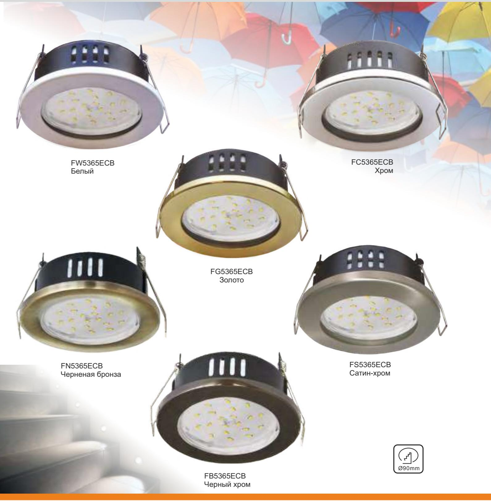
С фронтальной стороны светильник имеет степень защиты IP65 (пыленепроницаемый, защита от водяных струй с любого направления). Подходят как для внутреннего, так и для уличного применения. Корпус металлический, лампа за стеклом, две резиновые прокладки – под стеклом и по краю, который прилегает к установочной поверхности. Не рекомендуется устанавливать лампу более 6 Вт.
